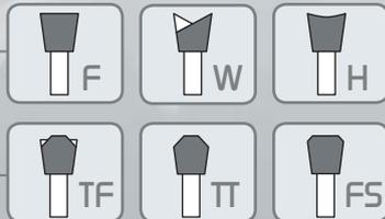
Größtenteils werden HDS-Kreissägeblätter mit dem universellen und einfach zu schärfenden Flachzahn ausgerüstet. Für spezielle Einsatzzwecke stehen weitere Formen bereit.
